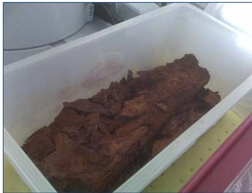
Fig. 1 - Echantillonneur de lingots de fer effrités © Virginie Serrière
