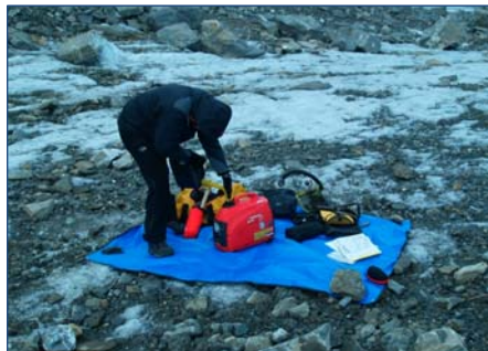
Fig. 4 – Isolation du matériel électrique à l'aide de couverture de survie, Loetschengletscher, Suisse, 2007 © Charlotte Rérolle
