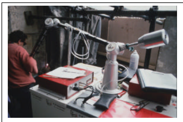
Photo 1 : prototype laser Nd YAG pulsé déclenché NL 00 de BMI à l'essai à la cathédrale de Rouen en 1993
